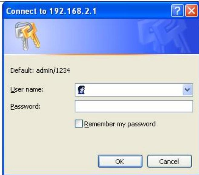
6. Inicie el navegador de Internet e inserte la dirección IP del router inalámbrico en la línea de dirección, seguidamente aparece el aviso siguiente. Inserte el nombre de usuario y la contraseña, haga clic en "Aceptar" para abrir la interfaz de usuario de administración de Internet del router inalámbrico.
