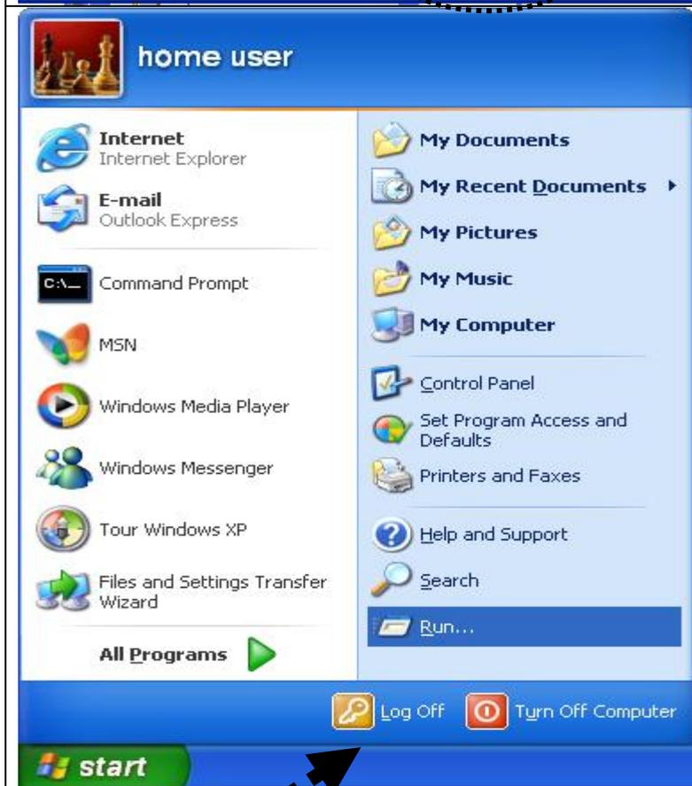
4. Una vez finalizada la configuración de la dirección IP haga clic en "Inicio" -> "Run/Ejecutar" en la parte inferior izquierda del escritorio, seguidamente inserte "cmd" y haga clic en "Aceptar"
